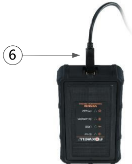
Figure 2-7 Vue inférieure du VCI
