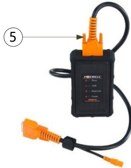
Figure 2-6 Vue de dessus du VCI
